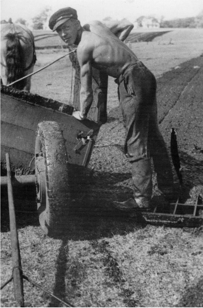
Figur 14. Rasmus Jensen, Thorsager, aldrig kaldt andet end "Ras Evald" (vel fordi faderen har heddet Evald?) tømmer dyndvognens æltede tørvemasse ud over rammerne, der former den til tørv. Når massen er hældt ud over rammerne, jævnes den med en skraber, der er et langt bræt på en stage, hvorefter den tørrer, så rammerne snart kan fjernes og bruges til næste læs. Når tørvene er tørre på oversiden, rejses de i rækker, "kantes", af kvinderne, så de kan tørre også på den anden side. Derefter stakkes de.
