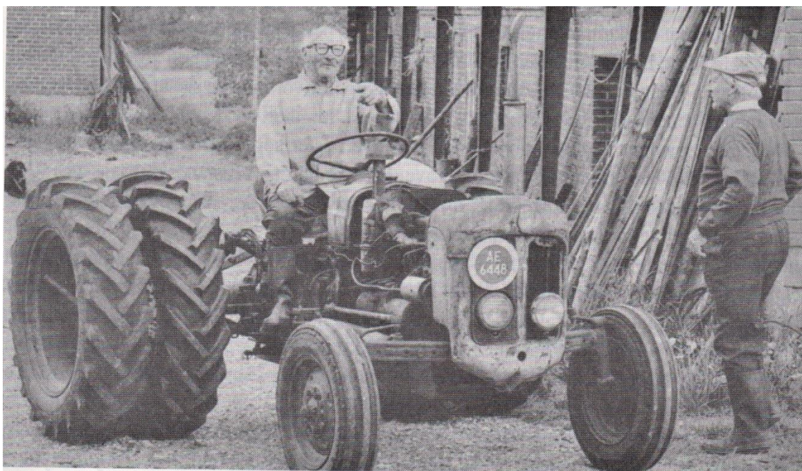
Julius Gregersen på sin godt 30 år gamle Fordson Dexta traktor, der altid står på en skråning – den skal nemlig løbes i gang. Bygningen i baggrunden har for en halv snes år siden fået nyt tag, der hviler solidt på de rejste jernbuer. Det gamle tag er nu godt beskyttet, og mellem de to tage er der plads til et utal af duer. Foto lånt af red. S. E. Olesen, Dagbladet
